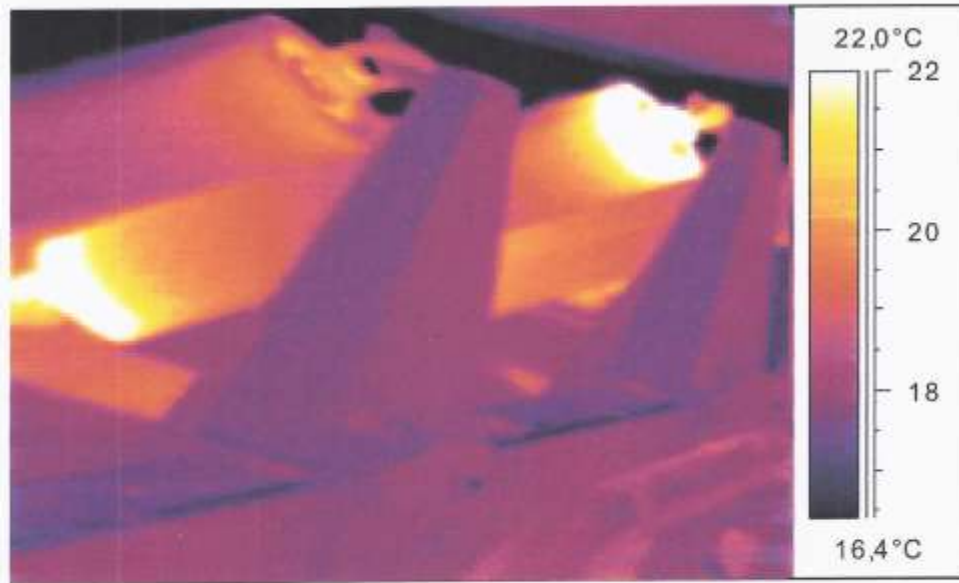
Rys. 1. Termogram uszkodzonych krążników przenośnika taśmowego
